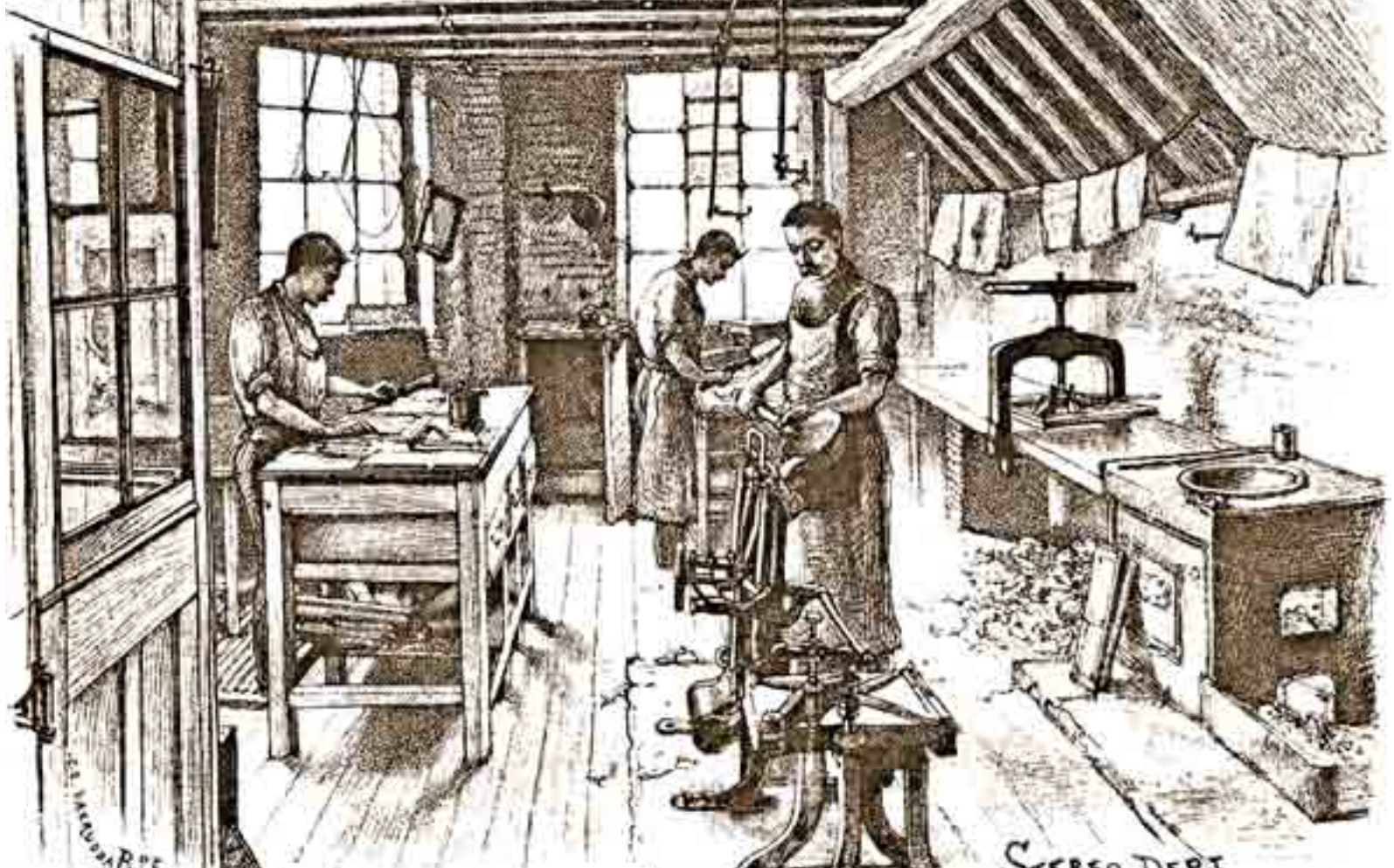
(شكل ١٠٣) قولبة (إستريوتيب) وهي طريقة صب الأسطح الطباعية (فورم) من سبيكة معدنية. يتم الحصول على هذه الفورم بالصب المتكرر في قالب صب مصنع من الورق "الماشيه" ويسمى "القالب الأم" (المتريس). تستخدم عمومًا في طبع الجرائد والمطبوعات الزهيدة الثمن
