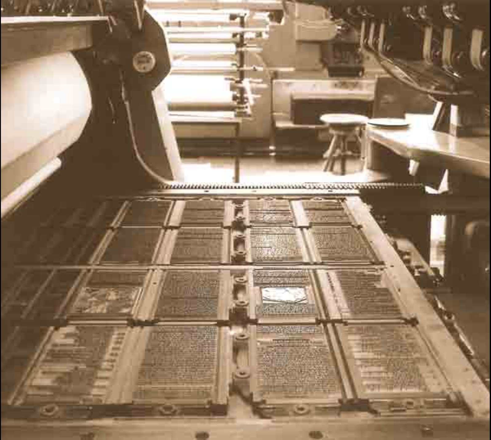
(شكل ٧٢) شكل الصفحة بعد تجميعها آلياً، وقد قسمت إلى صفحات تم تثبيتها بواسطة الأطواق الحديدية، ويوجد ببعض الصفحات أشكال لصور ورسومات.
