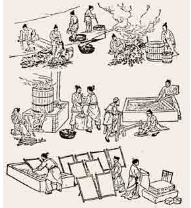
(شكل ٢٣) رسم تخطيطي يوضح عمليات صنع الورق في عهد أسرة هان.
