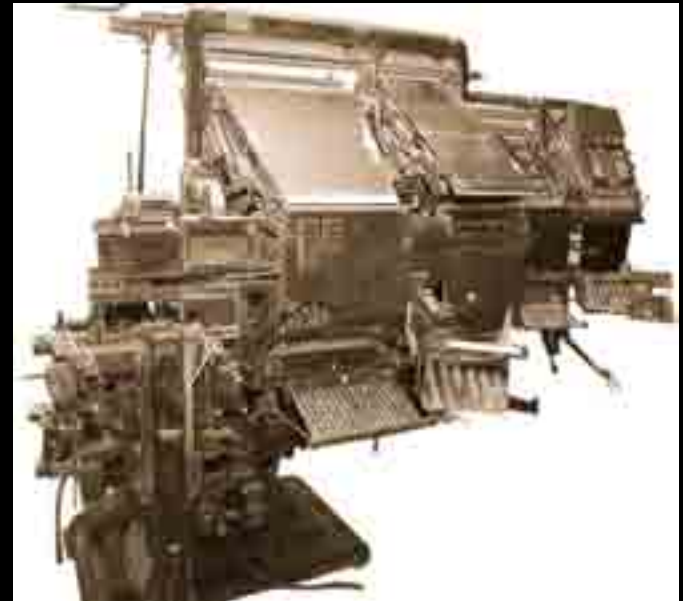
(شكل ٦٦) ماكينة الإنترتيب بمطبعة بولاق (صناعة إنجليزية) وتستخدم في الجمع الآلي على شكل أسطر متماسكة لجميع الأبناط.
