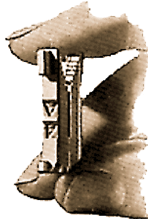
(شكل ٦٩) قالب صب الحروف، الذي يصب بداخله الرصاص المنصهر لتشكيل الحرف المطلوب.
